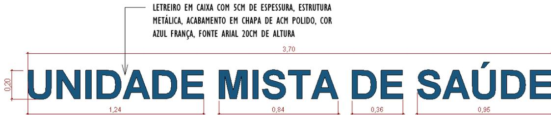
Letreiro em caixa com 5 cm de espessura, estrutura metálica, acabamento em chapa de ACM polido na cor Azul França, fonte: Arial, 20 cm de altura.
